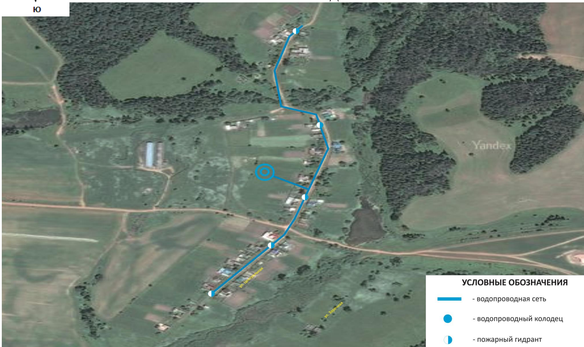
Карта (схема) существующего размещения объектов централизованной системы водоснабжения д. Подгорное
